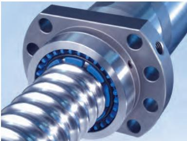
Der Doppelabstreifer wird dort eingesetzt, wo einerseits problematische Verschmutzungen vorkommen, andererseits aber auch nicht ausgeschlossen werden kann, dass Wasser bzw. wasserbasierte Kühlschmiermittel in Kontakt mit der Mutter kommen. In solchen Fällen kann der Filzabstreifer nicht ohne zusätzlichen Schutz eingesetzt werden, da der Filz sonst zur Wasseraufnahme neigt.
