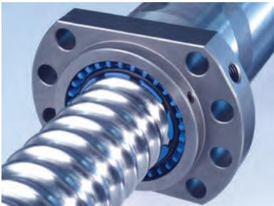
Kunststoffabstreifer oder Labyrinthdichtungen sind der Standard in Maschinenbauanwendungen. Sie verhindern zuverlässig das Eindringen von Spänen und groben Schmutzpartikeln, erlauben aber eine gewisse Leckage des Schmiermittels. In Verbindung mit einer automatischen Öl- oder Fettzufuhr ergibt sich so ein Spüleffekt der Mutter, die damit eine hohe Betriebssicherheit erreicht.
