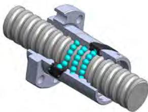
Charakteristikum der internen Umlenkung sind Umlenkstücke, die die Kugeln aus dem Gewindegang und über den Außendurchmesser der Spindel heben und in den unmittelbar nächsten Gewindegang leiten. Damit ist bereits nach einem Umlauf der Kugelkreis wieder geschlossen, so dass immer mehrere Umlenkstücke pro Mutter verwendet werden. Die Anzahl der „Umläufe“ ist damit gleich der Anzahl der „Kreisläufe“, die auch gleich der Anzahl der Umlenkstücke ist.
