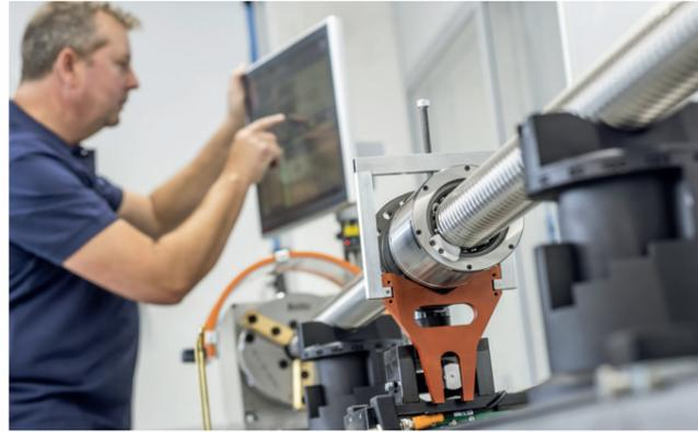
Bei Steinmeyer ist Stillstand ein Fremdwort. Wir investieren laufend in neue Fertigungsverfahren und die Modernisierung unseres Maschinenparks, um Kugelgewindetriebe höchster Güte herzustellen. Für eine optimierte Qualitätskontrolle haben wir neue Prüfstände errichtet, um zum einen besonders lange Spindeln zu testen und zum anderen die Zylindrizität des Spindelgewindes direkt nach dem Schleifprozess unter die Lupe zu nehmen.
