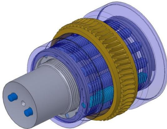
**Aufbau\_Differentialrollenspindel.jpg:** Der Aufbau einer Differentialrollenspindel ähnelt dem des Planetengewindetriebs, allerdings besitzen Mutter und umlaufende Rollen nur Rillen, keine Steigung
