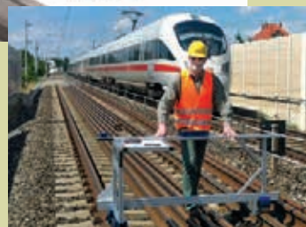
Gleiswagen, der aufrechtes Arbeiten ermöglicht.
